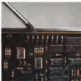
Sulle schede sono facilmente identificabili i portatori e gli jumper che permettono di attivare o meno determinate sezioni della motherboard
